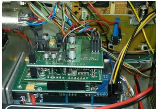
**Figura 6.** Detalle del montaje e integración de las diversas partes del equipo construido. (Se observan: la tarjeta Arduino Mega, el módulo GSM/GPRS, el potencióstato y el convertidor DC-DC montados en forma vertical).
