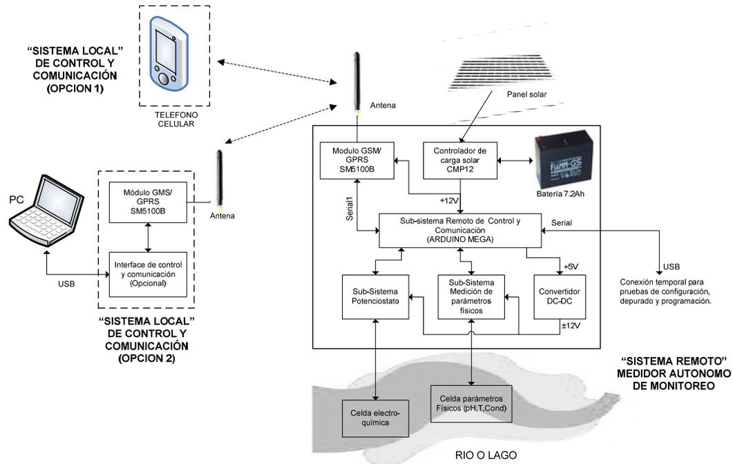
**Figura 1.** Diagrama de bloques del sistema desarrollado.
