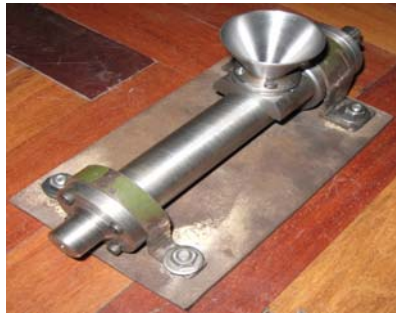
Figura 1. Extrusora construida para la obtención del compuesto polímero-madera.
