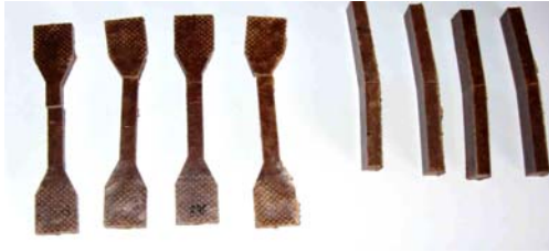
Figura 3. Vista de las probetas después de los ensayos de tracción y flexión.
