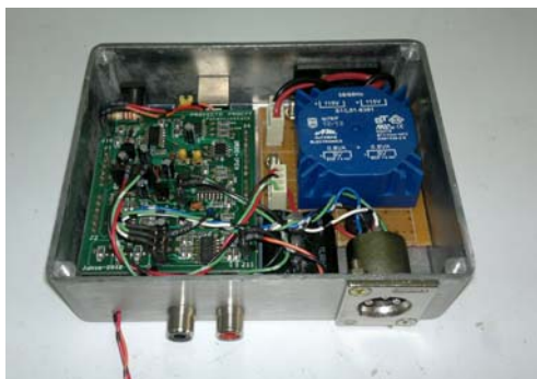
Figura 4. Gabinete de aluminio conteniendo la tarjeta de potenciostato, tarjeta arduino Duemilanove y tarjeta de alimentación de voltajes.
