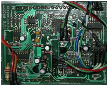
Figura 1. Primer plano de la tarjeta analógica del potencióstato para ser montada como shield sobre una tarjeta Arduino Duemilanove.
