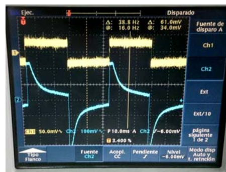
Figura 5. Señales del potencial de excitación de onda cuadrada (trazo superior) y corriente transitoria de repuesta (trazo inferior), obtenidas empleando como electrodo de trabajo un disco de cobre de 160 \mu\text{m} .
