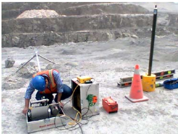
Figura 4. Instalación de sistema SIROLOG para la medida por PGNAA en una perforación de voladura en la cantera de Atocongo, Cementos Lima S.A.
