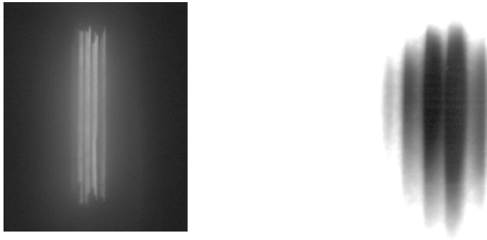
Figura 2. Registros del haz transmitido por el Soller a 0 cm de la salida del colimador, derecha fuente de luz, a la izquierda haz de neutrones.
