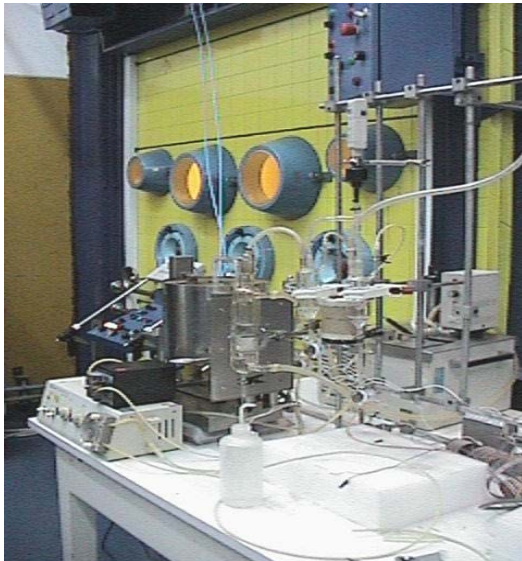
Figura 1. Ensamblaje de los sub-sistemas para la celda de producción de ^{131}\text{I} .
