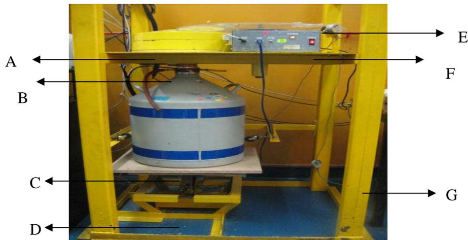
**Figura 4. Configuración estructural de sistema de espectrometría gamma de alta resolución; A: Blindaje de plomo de 140mm de espesor; B: Detector semiconductor de GeHp (dentro del blindaje); C: Termo criogénico de nitrógeno líquido; D: Gata hidráulica de 2 T de carga; E: Disco de acrílico de 6 posiciones; F: Caja de comandos de intercambiador; G: Estructura metálica de acero tubular**
