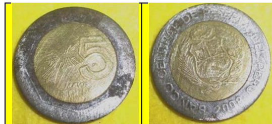
Figura 4. Es visible la oxidación que presenta la superficie de la moneda falsa de 5 Nuevos Soles.
