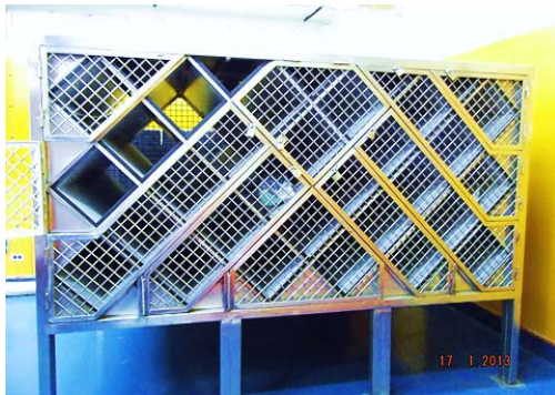
Figura 1. Armario de EECC no irradiados.
