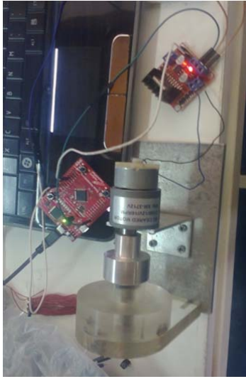
Figura 7. Implementación preliminar del circuito de control.
