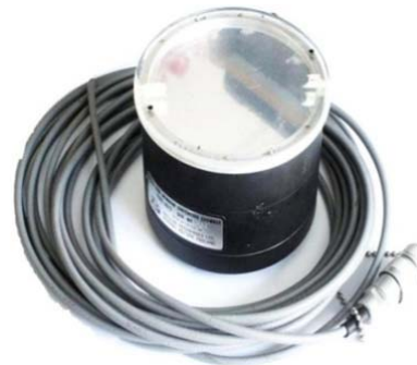
Figura 5. Cámara de ionización de 600\text{ cm}^3 Marca Nuclear Enterprises modelo 2535/1 y serie 403.
