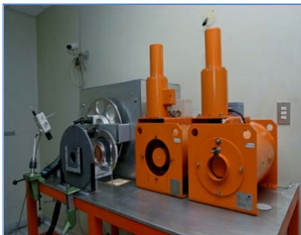
Figura 3. Los haces de radiación son proporcionados por los irradiadores de ^{137}\text{Cesio} , Modelo OB6, Marca STS y de rayos X, Modelo ISOVOLT 225, Marca Pantak Seifert.
