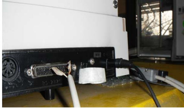
Fotografía 1. Puerto Serial RS-232 de la balanza (Sensor)
