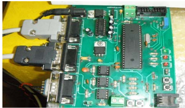
Fotografía 2. Conexión de la balanza al UART del PIC 18F458
