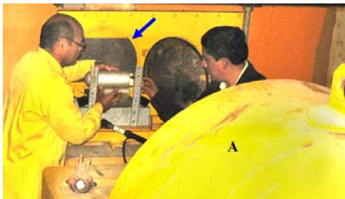
Figura 4. Instalación de una cámara de ionización en la salida del haz de neutrones del RP-10 para la correspondiente prueba neutrográfica, delante se aprecia parte del atenuador de neutrones A.
