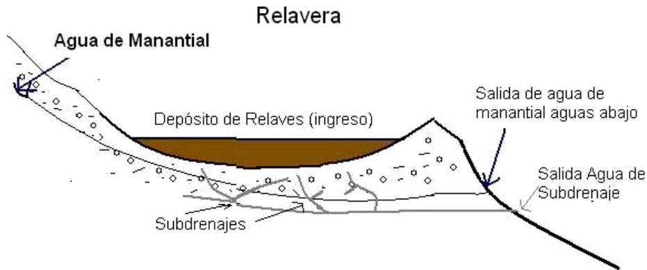
Figura 1. Corte esquemático de la Relavera.
