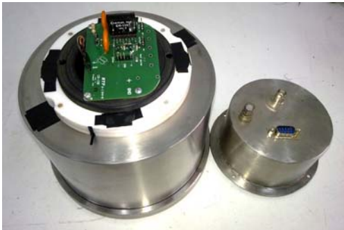
Figura 4. Fotografía del módulo preamplificador CR-110 y tarjeta de montaje CR-150 instalados en el soporte de polietileno sobre la cámara de medición.
