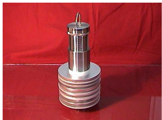
RACK de Corrosión y Cupones ensamblados
