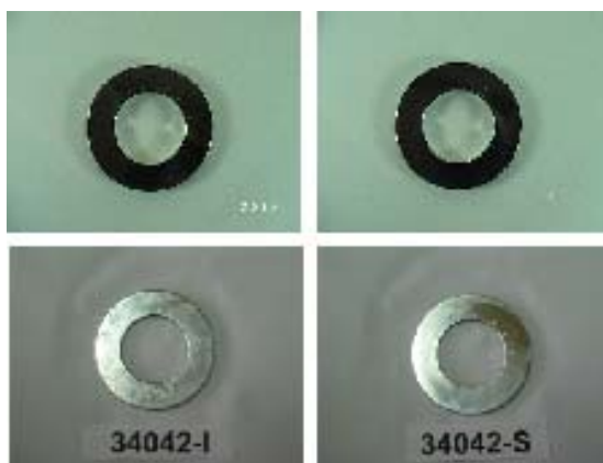
Cupones de Corrosión antes y después de la inmersión de la aleación SS 304 de su anverso (S) y su reverso (I), con cupla con AA 1050
