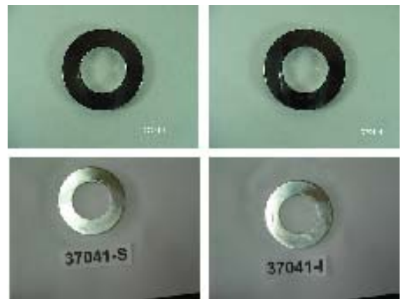
Cupones de Corrosión antes y después de la inmersión de la aleación SS 304 de su anverso (S) y su reverso (I), con cupla con AA 6061
