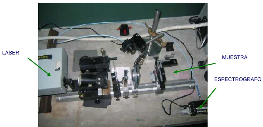
**Figura 2.** Disposición de los elementos en el sistema LIBS.
