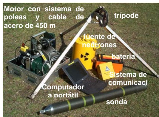
Figura 4. Todas las componentes del sistema SIROLOG.
