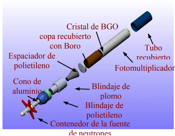
Figura 3. Esquema de la sonda del sistema SIROLOG.
