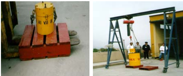
Figura 4. Transporte y colocación en cilindros de 200 litros.
