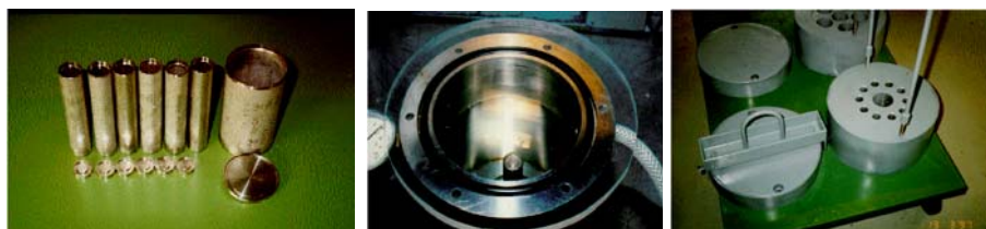
Figura 2. Cápsulas y blindaje para almacenamiento de fuentes de Ra-226
