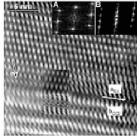
Figura 11. Análisis de la interfase entre el fosfato octacalcico y la hidroxiapatita. El recuadro representa la imagen simulada a partir del modelo y cuyo contraste concuerda con la imagen experimental. Los recuadros A y B presentan los patrones de difracción de la hidroxiapatita (A) y del fosfato octacalcico (B). Si se observa esta imagen de forma razante a lo largo de la flecha doble, se define una dislocación claramente.
