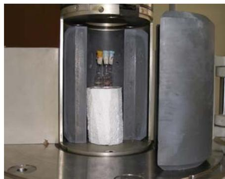
**Figura 6.** Posición de Dosímetros con el atenuador de 10% transmisión.
