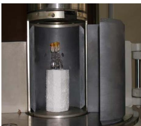
**Figura 4.** Posición de Dosímetros con el atenuador de 50% transmisión.
