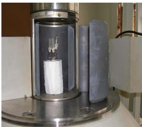
**Figura 5.** Posición de Dosímetros con el atenuador de 30% transmisión.
