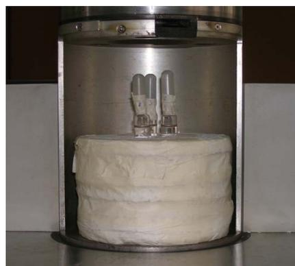
Figura 3. Posición de dosímetros en el centro de la cámara de irradiación.
