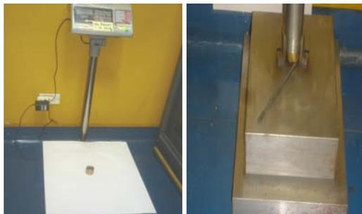
**Figura 7.** Martillo de impacto para el punzado e impacto sobre la cápsula.
