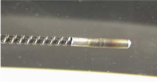
**Figura 2.** Inspección visual de la soldadura dentro del recinto de producción.
