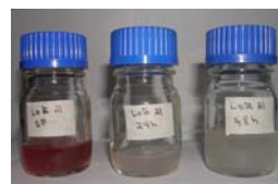
Fotografía 16. Frascos con gel almacenado durante 15 días en refrigeración; obtenido de hojas recolectadas y procesadas a partir de un mismo lote: A la izquierda, sin procesar, en el centro, 24 horas de remojo y a la derecha, 48 horas de remojo.
