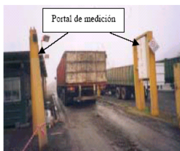
Figura 1. Equipo de medición de radiación en empresa de chatarra.
