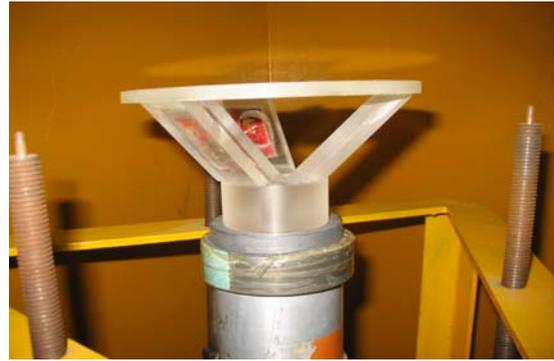
**Figura 1:** Soporte de fuente Am-241 sobre detector Si-Li.
