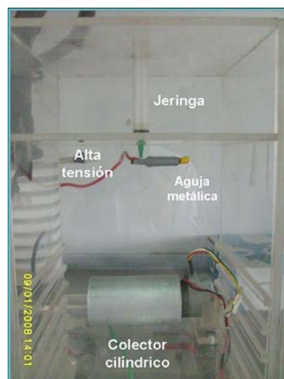
Figura 4: Sistema para electrogirado con colector cilíndrico.
