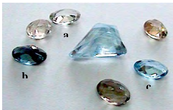
Figura 8. Fotografía de (a) un topacio incoloro, antes de ser irradiado y topacio (b) azul, y (c) celeste obtenidos después de ser irradiados en el reactor RP-10.
