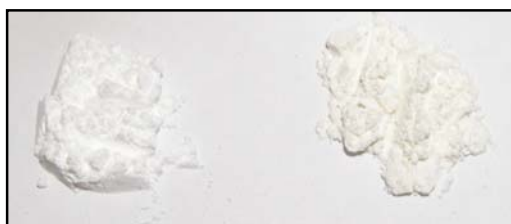
Figura 2: Diferencia de color entre muestras de Acetato de Medroxiprogesterona irradiadas a 0 (izquierda) y 40 kGy (derecha).
