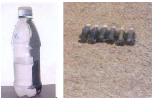
Figura 2. (a) Detalle de la botella de plástico PET pintada de negro. (b) Detalle de su irradiación solar.
