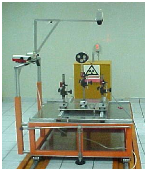
Figura 1. Irradiador panorámico implementado en el LSCD/IPEN.
