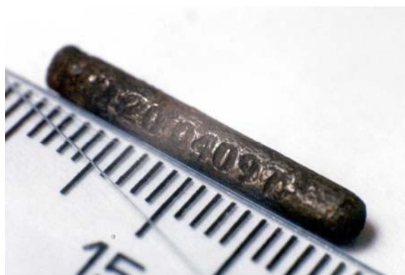
Fotografía de la Fuente perdida. El color negro es debido a que la fuente fue incinerada junto con los residuos del hospital.
