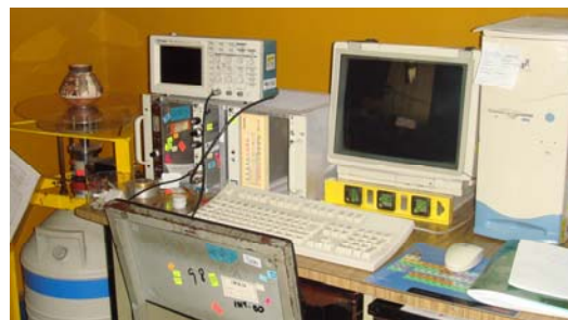
Figura 5. Sistema de FRXED para análisis no destructivo de pigmentos.
