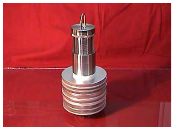
RACK de Corrosión y Cupones ensamblados
