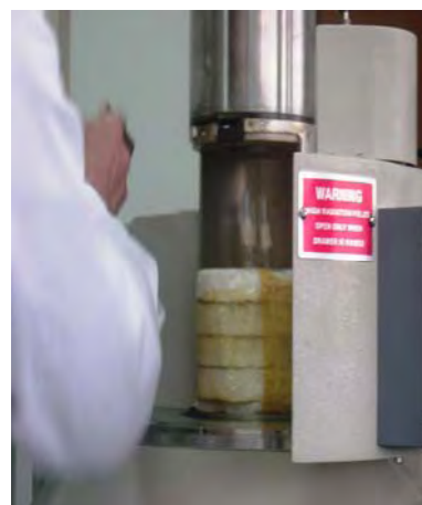
Foto 2. Posición de Dosímetros Fricke en el centro de la cámara de Irradiación.
