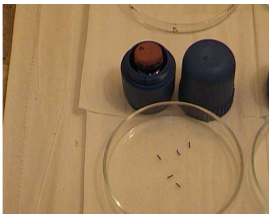
Grupo de alambres de plata recubiertas con paladio después del proceso de adsorción de ^{131}\text{I} durante 6 horas
