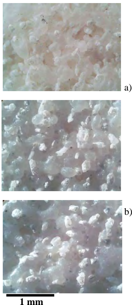
Figura 9. TiO 2 en polietileno. En el material compuesto, se observó un efecto bacteriostático, es decir las bacterias no crecen en su superficie.
