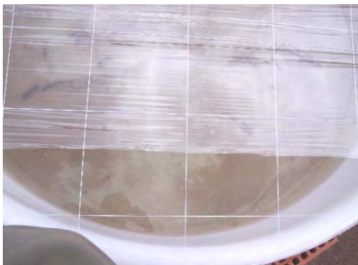
Figura 10. Detalle de la cubierta de polietileno implementada en el reactor.
