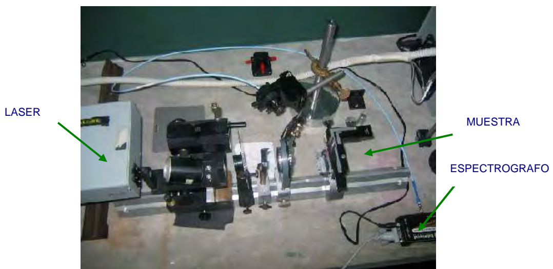
Figura 2. Disposición de los elementos en el sistema LIBS.
