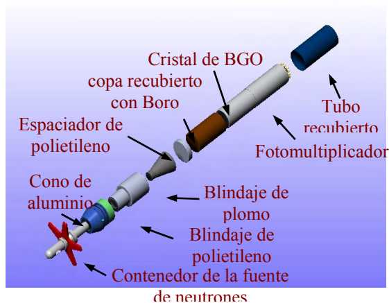
Figura 3. Esquema de la sonda del sistema SIROLOG.
