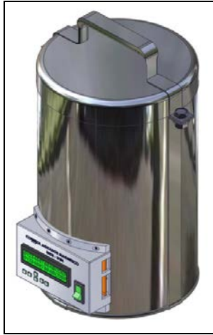
Figura 4. Equipo de disolución de muestras radiactivas.
