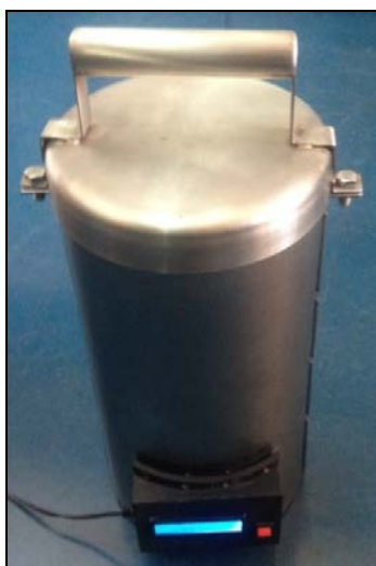
Figura 14. Equipo para disolución de muestras radiactivas.
