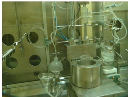
Figura 3. Imagen del recinto de producción Tc-99m, vista interior.
