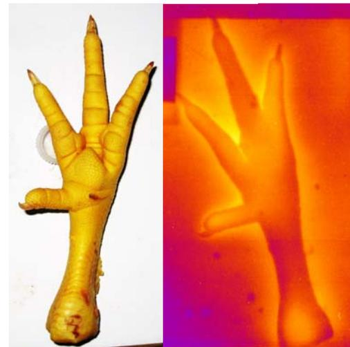
**Figura 4.** Par neutrográfico positivo en falso color de una pata de pollo fresco.
