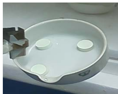
Figura 2. Pastillas \text{MoO}_3 después de la eliminación del agente aglutinante-PVA, mostrando color blanco.
