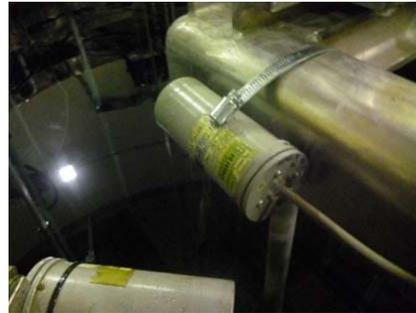
**Figura 2.** Detalle de la instalación del medidor de tasa de exposición.
