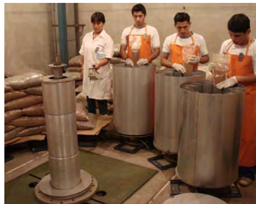
Figura 5: Preparación de las muestras y dosímetros en el equipo GB-147
