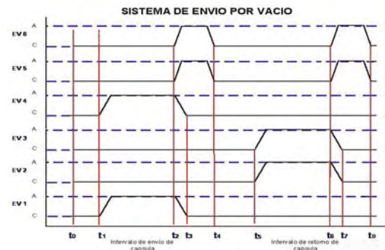
Figura 4: Diagrama espacio - tiempo sobre apertura y cierre de las electroválvulas.
