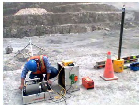
Figura 2: Instalación de sistema SIROLOG en una perforación de voladura en la cantera de Atocongo.
