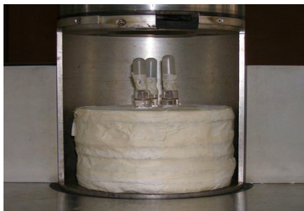
Figura 4: Posición de los dosímetros en Aire en Gammacell 220 Excel.
