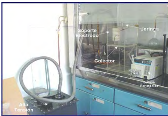
Figura 3: Sistema para electrogirado.
