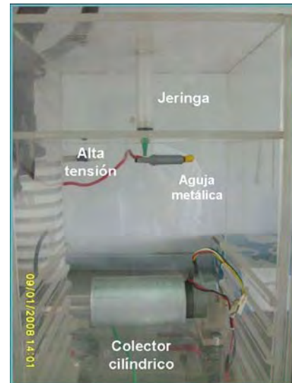
Figura 4: Sistema para electrogirado con colector cilíndrico.
