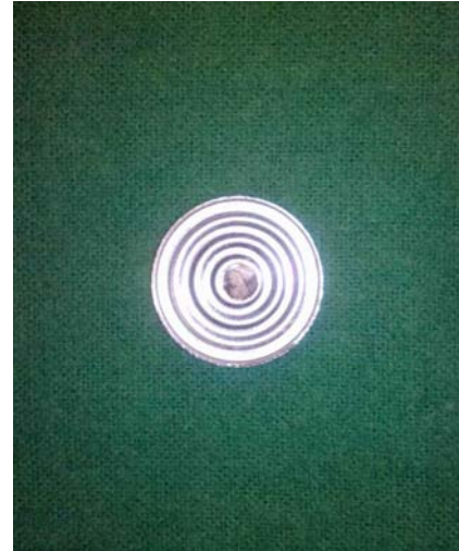
Figura 4. Fuente gruesa de Am-241 (pararrayos).
