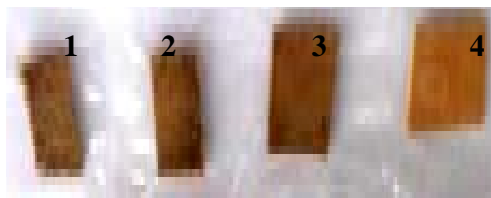
Figura 3. 1, 2 y 3 corresponden a muestras de compuesto madera-polímero y 4 es madera Capirona.
