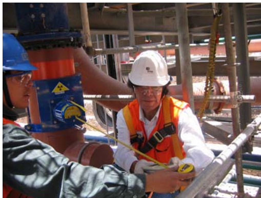
Figura 3. Verificación de tasa de dosis a 1 metro.
