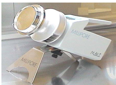
Figura 2. Contador de microbiológico de aire M Air T marca MILLIPORE.
