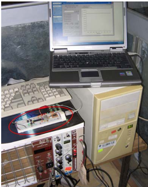
Figura 3. Imagen mostrando el protoboard (círculo rojo) montado con el módulo MCS conectado a una computadora portátil y a la cadena de instrumentación.
