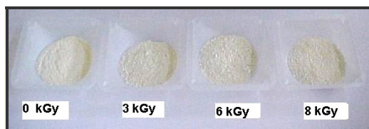
Figura 1. Diferencia de color entre muestras de concha de nácar en polvo, irradiadas a 0, 3, 6 y 8 kGy.
