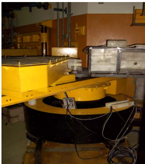
Figura 2. Primer plano del segundo eje. Se observa a la izquierda el gabinete que contiene el detector, al medio la posición de la muestra y a la izquierda, vista parcial del colimador.
