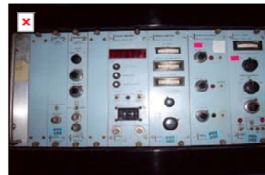
Figura 1. Módulos de la cadena de arranque del reactor RP-0 desde mesa de control.
