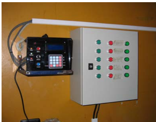
Figura 4. Módulo de control electrónico a la izquierda y tablero para pruebas manuales a la derecha.
