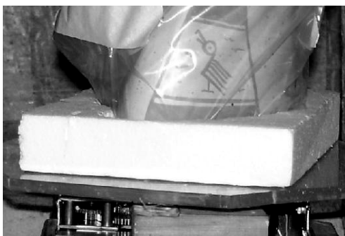
Figura 2. Dispositivo rotatorio de irradiación. Se muestra una parte del objeto cerámico en estudio.
