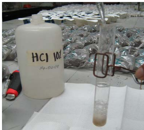
Figura 2. Determinación de carbonatos según el grado de efervescencia.
