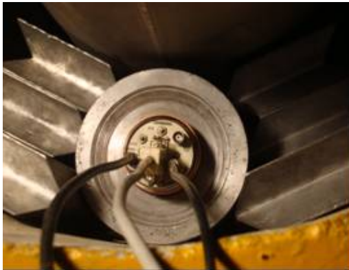
Figura 3b. Disposición del detector de INa(Tl) y el nuevo colimador (espesor de pared 4 cm).
