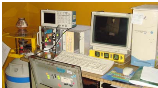
Figura 5. Sistema de FRXED para análisis no destructivo de pigmentos.
