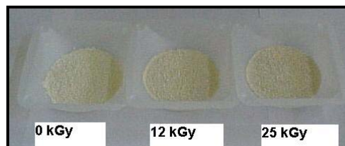
Figura 3. Diferencia de color entre muestras de Omeprazol en pellets irradiadas a 0, 12 y 25 kGy.
