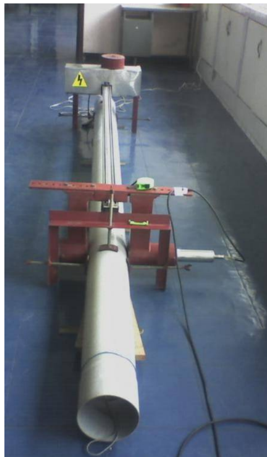
Figura 3. Columna evaluada con perfilaje gamma.
