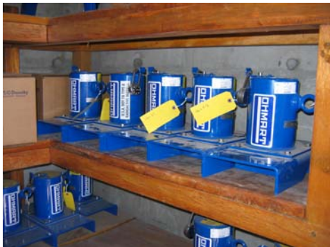
Figura 6. Ubicación de medidores nucleares al interior del almacén.
