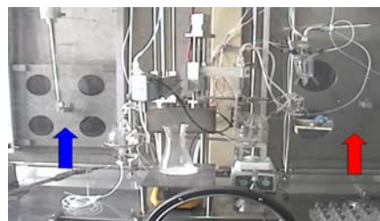
Figura 8. Puertas de esclusa de transferencia (flecha azul) y puerta de mantenimiento (flecha roja).
