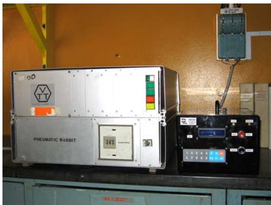
Figura 5. Módulo de control original (izquierda) y el nuevo módulo desarrollado (derecha).
