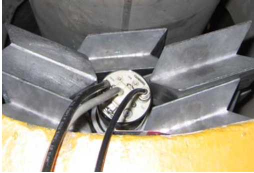
Figura 3a. Ubicación del detector de NaI (TI) y el colimador de prueba (espesor de pared 2 cm).
