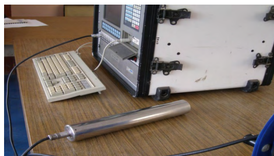
Figura 2. Sistema de adquisición de datos con sonda.
