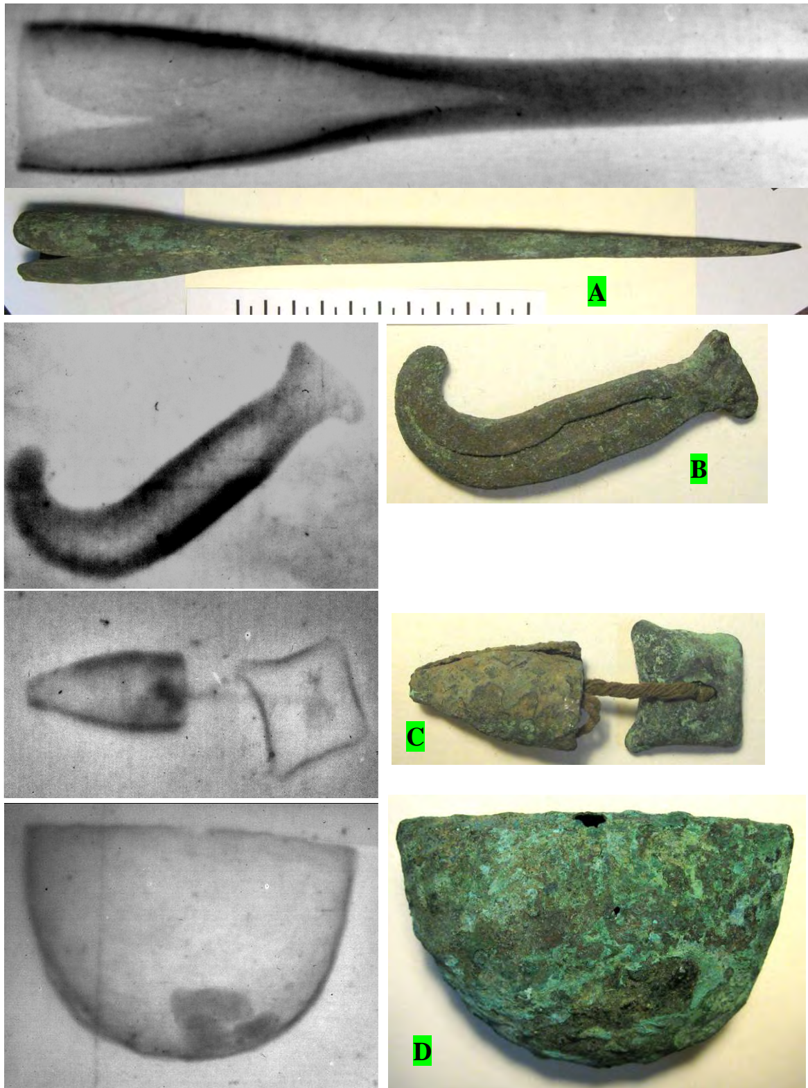
Figura 7. Neutrografías en tamaño natural y sus correspondientes imágenes reales de piezas arqueológicas metálicas correspondientes al período Intermedio Tardío (1000 – 1470 d. C.), su procedencia conocida es la costa norte del Perú. Como se puede apreciar, las piezas aún no han sido restauradas, motivo por el cual las neutrografías muestran con alto contraste las capas afectadas por la corrosión y en el caso D muestra la presencia de tres piedras al interior. A) Punta de 27 cm de long. B) Gancho. C) Campanilla y D) Chalchalcha o sonaja.
