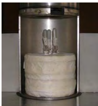
Figura 3: Posición de los dosímetros en aire en Gammacell 220 Excel.
