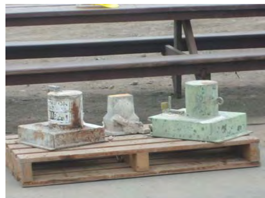
Figura 7. Fuentes radiactivas liberadas para ser acondicionadas en bultos especiales.
