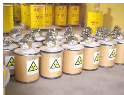
Figura 1. Pararrayos radiactivos almacenados en la PGRR.
