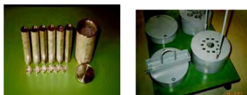
Figura 2. Cápsulas de acero inoxidable y contenedor de plomo.
