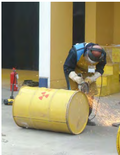
Figura 1. Procedimiento de cortes en las bases del cilindro.
