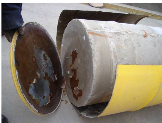
Figura 2. Retiro de tapas laterales de cilindro y abertura transversal.
