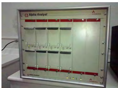
Figura 2. Sistema de espectroscopía alfa integrado.
