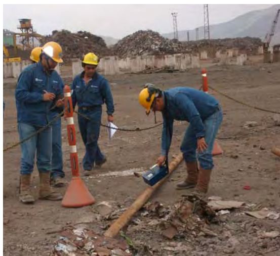
Figura 2. Medición de tubo metálico con presencia de material NORM.
