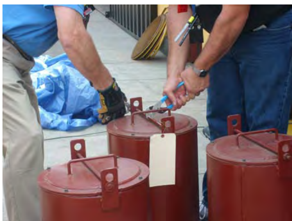
Figura 1. Contenedores especiales certificados para transportar fuentes de radio-226.
