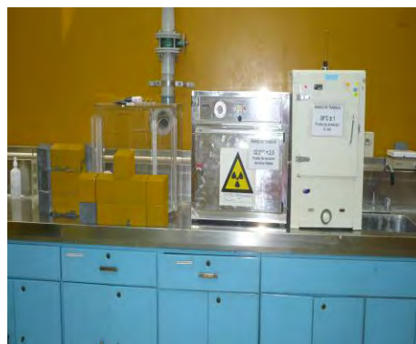
Figura 3. Zona de trabajo del control microbiológico, a) Caja de Guantes con extracción de aire, y b) Ladrillos de plomo para la protección del operador.
