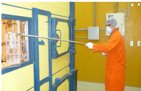
Figura 2. Transporte de las muestras con tele pinza al ingreso y salida del recinto de fraccionamiento.
