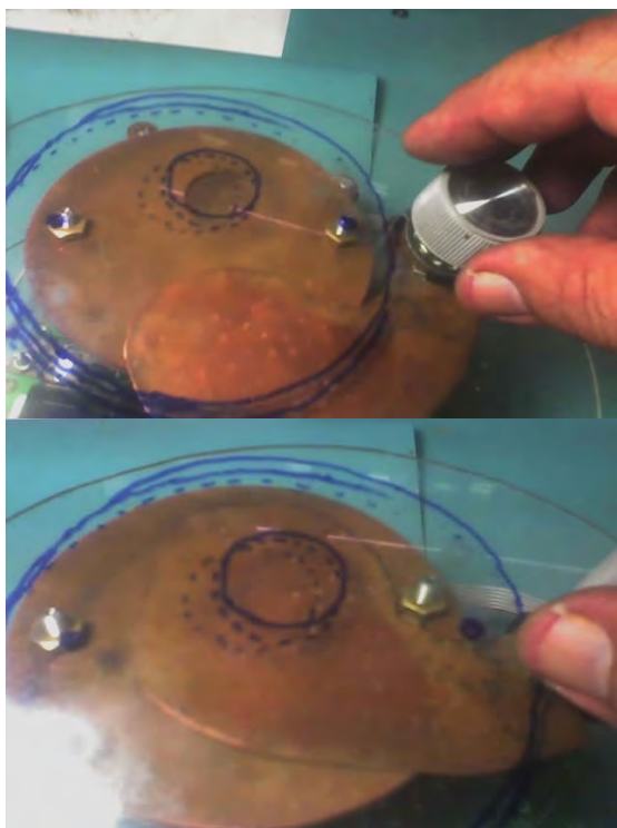
Figura 4. Foto del módulo detector extraíble con su obturación manual de filtro adicional para el rango de altas energías (65-125 keV).
