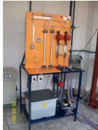
Figura 9. Sistema de Control de Columna de Intercambio Gas Líquido. (Fuente: Laboratorio de Instrumentación, CNEN- IPEN-Brasil).
