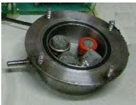
Figura 2. Cámara de la nariz electrónica diseñada y construida.
