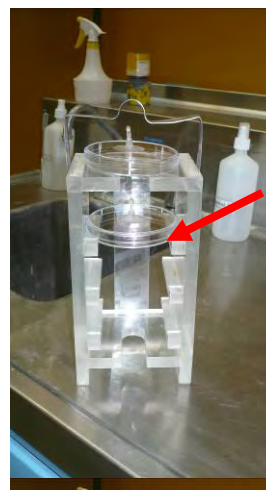
Figura 1. Porta placas de acrílico, y placas petri con disco adhesivos con ganchos de plástico de 25 mm x 25 mm.
