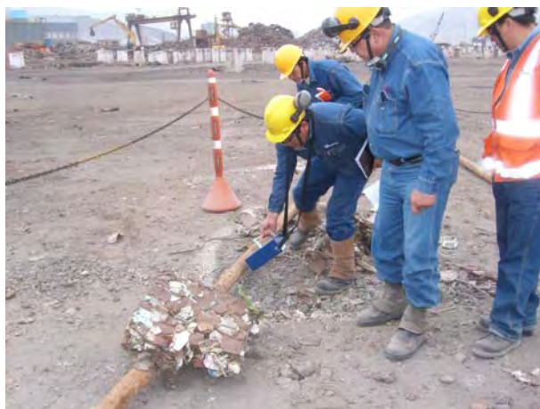
Figura 1. Ejercicio de mediciones a material separado de chatarra e identificando respuesta de monitor.
