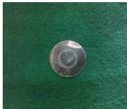
Figura 1. Fuente de Am-241 electrodepositada, delgada.
