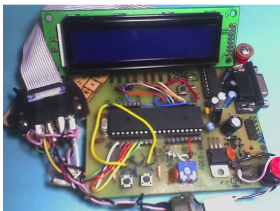
Figura 8. El Visor (Display) LCD de 20 x 2 se conecta a similar (y más simple) ‘Port C’ del Xmega 64, como se ve en el Atmega32.
