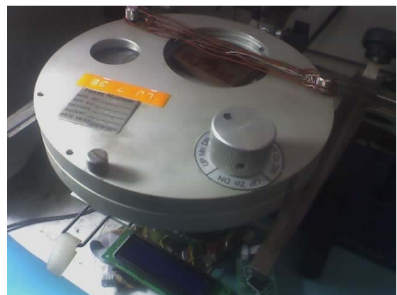
Figura 6. Fuente radiactiva de rayos X 40-99 keV.
