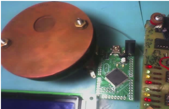
Figura 3. Foto del módulo detector extraíble: En vista superior (donde recibe los rayos X).
