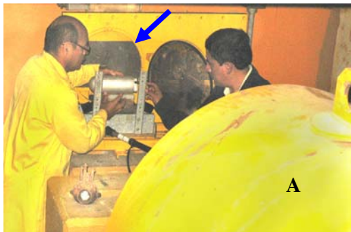
Figura 1. Instalación de una cámara de ionización en la salida del haz de neutrones del RP-10 para la correspondiente prueba neutrográfica, delante se aprecia el atenuador de neutrones A.
