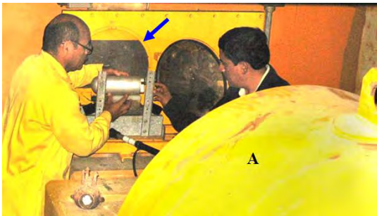
Figura 4. Instalación de una cámara de ionización en la salida del haz de neutrones del RP-10 para la correspondiente prueba neutrográfica, delante se aprecia parte del atenuador de neutrones A.
