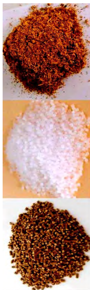
Figura 5. En la parte superior se muestra los residuos de aserrín, en el medio los pellets de polietileno y abajo están los pellets del compuesto obtenidos de la extrusora.
