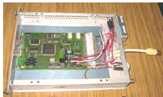
Figura 5. Acondicionamiento de la Tarjeta IAEA DAQ-52 en un módulo NIM.
