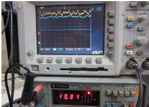
Figura 7. Muestra del filtraje de 2.8 a 0.8 MW. en el osciloscopio y lectura de potencia del RP-10 en el multímetro digital TRIO.
