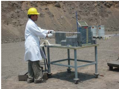
Figura 3. Utilización de telepinzas para ganar distancia.
