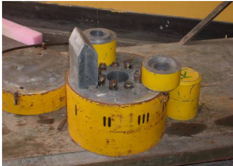
Figura 6. Colocación de cápsulas en contenedor de plomo.
