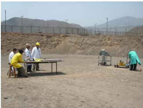
Figura 4. Medición y registro de tasas de dosis a distancia.
