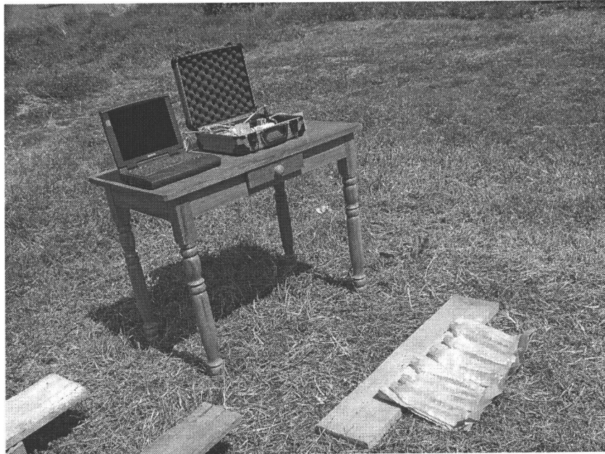
Figura 23. Fotografía del sistema en Yaurisque con las botellas en posición expuestas a la radiación solar.
