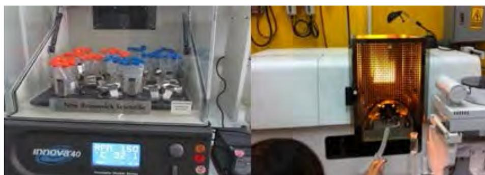
**Figura 3.** Izq.: Sistema de Incubación en agitación para sorción del plomo Der.: Espectrómetro de absorción atómica AA800 modelo AS-90 marca Perkin Elmer, técnica de flama usando una lámpara de EDL para Pb, energía 73, longitud de onda 283.3 (Laboratorio de Técnicas Analíticas Nucleares de la Dirección INDE-IPEN).
