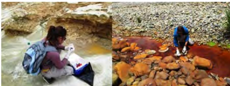
**Figura 2.** Izq.: Toma de muestra sólida (punto 2) del depósito de relave Ticapampa- Recuay. Der.: Toma de muestra líquida (punto 5) del depósito de relave Ticapampa (Recuay, Ancash.)
