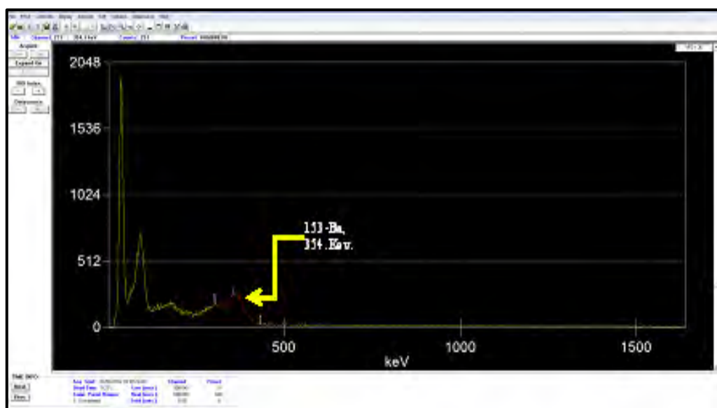
Figura 1. Calibración del equipo, se observa el espectro del patrón de ^{133}\text{Ba} , con el programa de adquisición de espectro Genie-2000.
